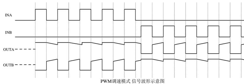
当输入信号 INA 为 PWM 信号，INB=High（或者 INA=High，INB 为 PWM 信号）时，马达的转动速度将受到 PWM 信号占空比的控制。在这个模式下，马达驱动电路输出在导通和刹车模式之间。
