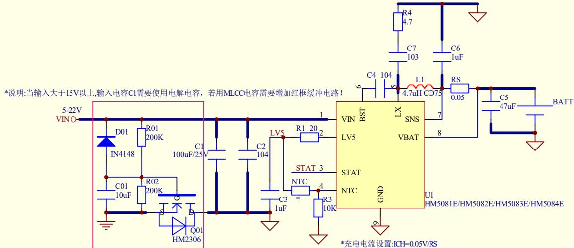
\*充电电流设置:  $I_{CH} = 0.05V / R_S$
